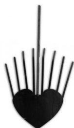
Рисунок 6 - Картофелекопатель, закрепленный на сцепке мотоблока, состоящий из плуга с приваренными к нему стальными прутьями
