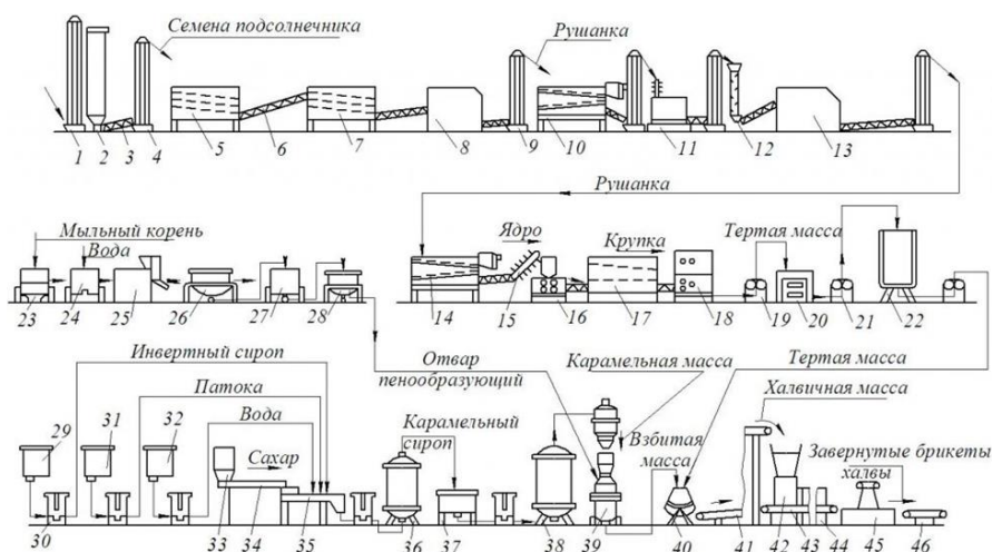
Рисунок - Машинно-аппаратурная схема линии производства подсолнечной халвы
