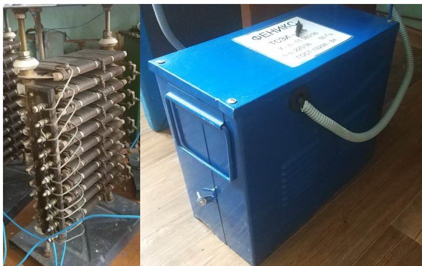
Рисунок 1 –Блок резисторов ЯС-3(а); Трансформатор ТСЗИ-6,3 (б)
