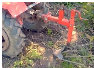
Рисунок 6 - Картофелекопатель, закрепленный на сцепке мотоблока, состоящий из плуга с приваренными к нему стальными прутьями
