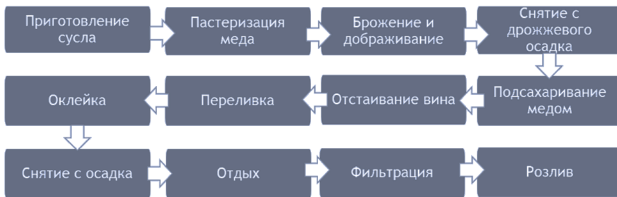
Рисунок 1 - Принципиальная технологическая схему выработки медовых вин
