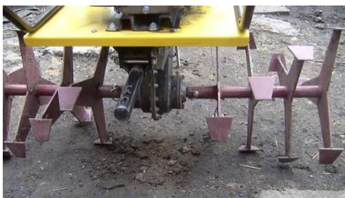
Рисунок 4 - Фреза «гусиные лапки»
