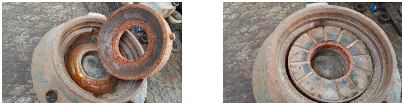
Рис. 2 - Изношенные подпятники насоса ЭЦВ10-120-60
